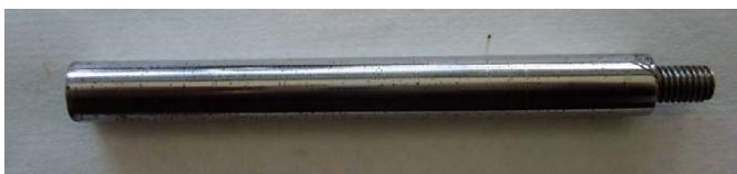
Рис. 1. Вид купона с незначительной точечной коррозией поверхности
