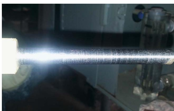
Рис. 9. Состояние купона, снятого из «Станции по контролю скорости коррозии в оборотной воде», непосредственно после извлечения, необработанного
