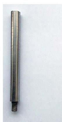
Рис. 10. Состояние купона, снятого из «Станции по контролю скорости коррозии в оборотной воде», после обработки
