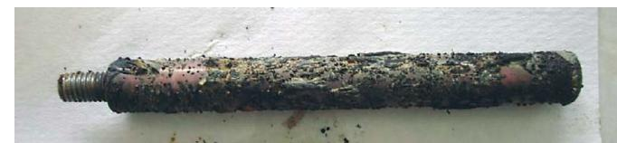
Рис. 2. Вид купона с отложениями металлической меди на поверхности
