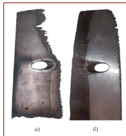
Рис. 6. Эрозия вершин рабочих лопаток последних ступеней турбин К-300-240 ХТГЗ при отсутствии (а) и наличии (б) водоотбойников на внутреннем конусе выхлопного диффузора
