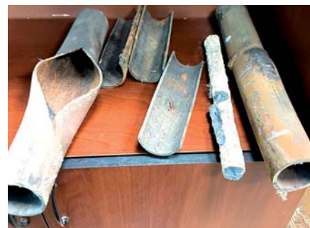
Лопнувшие экранные трубы энергетического котла
