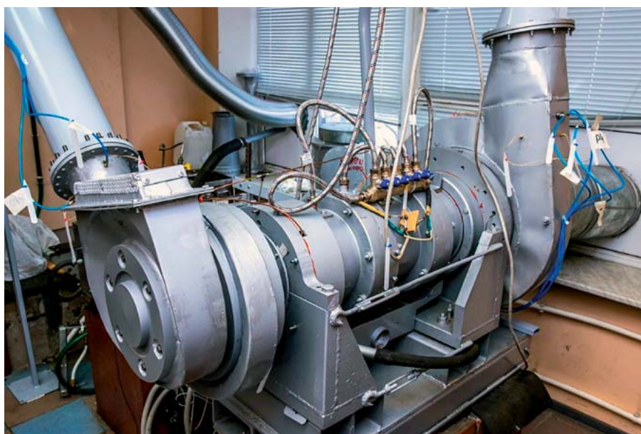
Стенд для исследования компрессоров и турбин мощностью до 500 кВт
